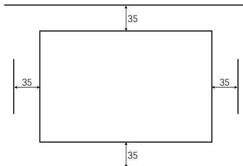
Distanze minime per il montaggio (indicazioni in mm)
